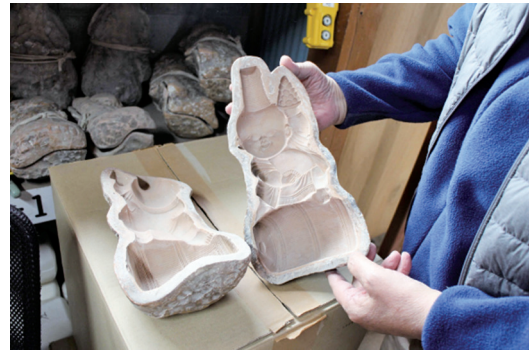
写真2 江戸時代から使われ続けている土型 （摩耗しにくい、粘土の水分を吸い取る容積が少ないため、大量生産には不向きとのこと）
