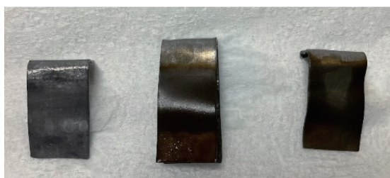
図 12 放電後の電極板の様子 (左から負極, 正極, 正極)
