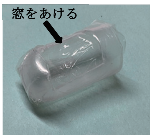
図5 ポリスポイトに半透膜を固定
