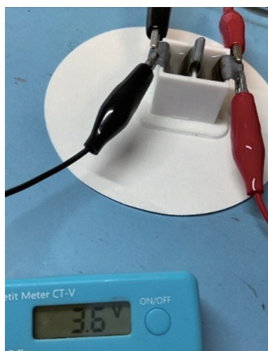
図 11 2 個の直列接続をした 鉛蓄電池の放電
