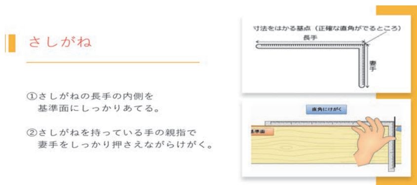
図1 さしがねの使用方法
