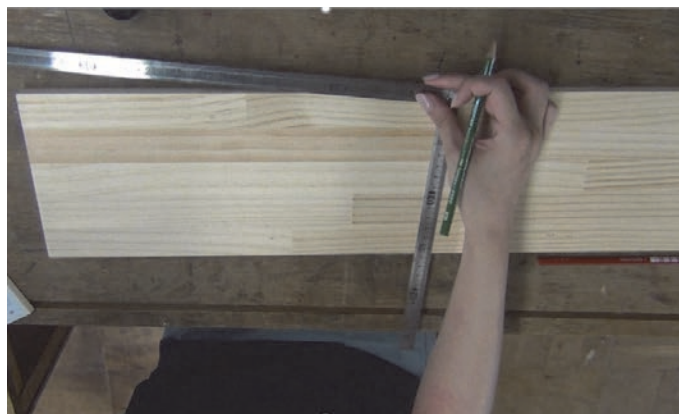
図3 けがきの実演をしている様子の動画（静止画に変換）
