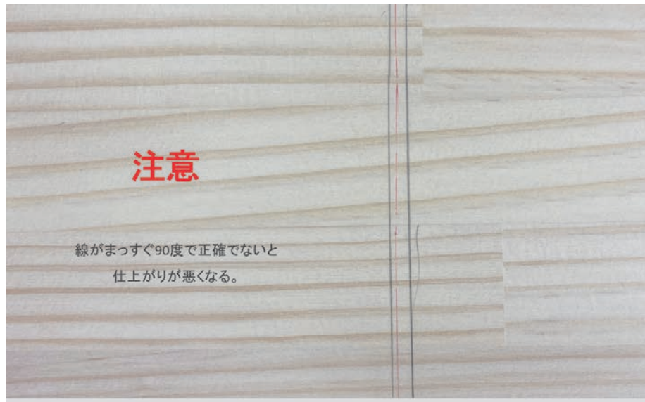
図6 けがきの修正が必要な事例
