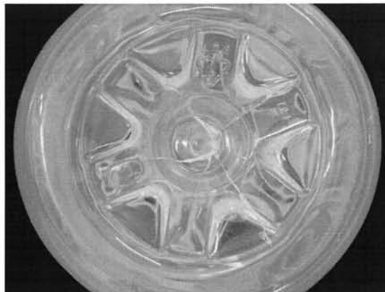
図2 ペットボトルの底(径8cm)の亀裂
