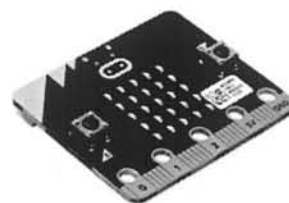
図 1 micro:bit V1.5 (4×5cm)
