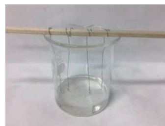
図 6 割りばしを用いた吊るし方
