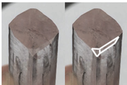
図8 成長させた結晶に見られた特徴的な結晶面
