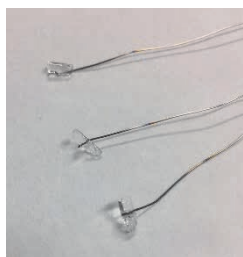
図 4 ステンレス線に取り付けた種結晶
