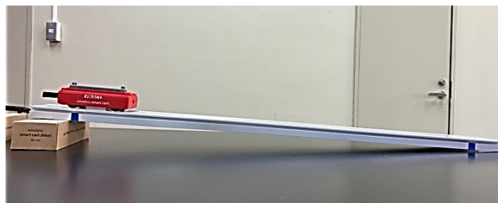
図 4.2.4-3 実験 C の様子（斜面を下るおもりを乗せた台車）
