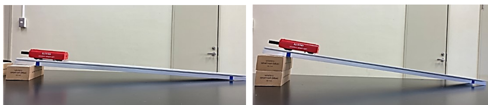
図 4.2.4-2 実験 A, B の様子（傾斜の異なる斜面を下る台車）
