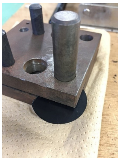
図 4-8 左：丸抜きカッター、 右：打ち抜いた接着剤 (stycast)
