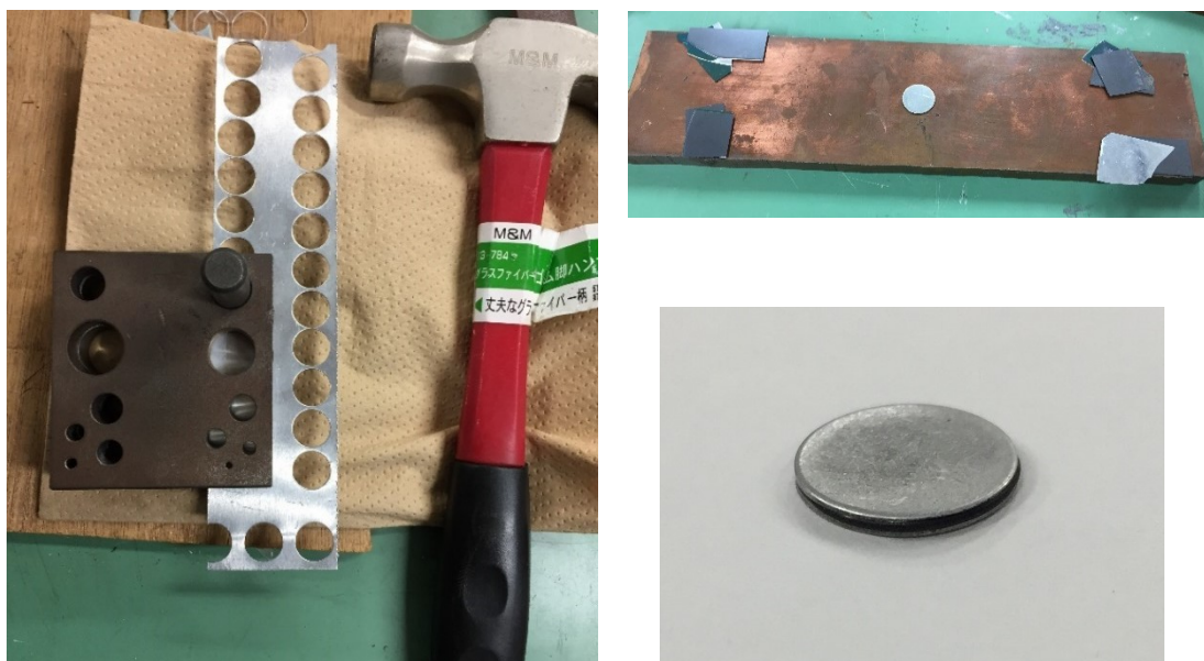
図 4-4 左：丸抜きカッター、右上：銅板・アルミコイン・スペーサー、右下：完成サンプル
