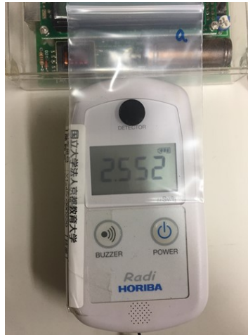
図 5-7 「PA-1000 Radi (ラディ)」で照射サンプルの放射線量を測定
