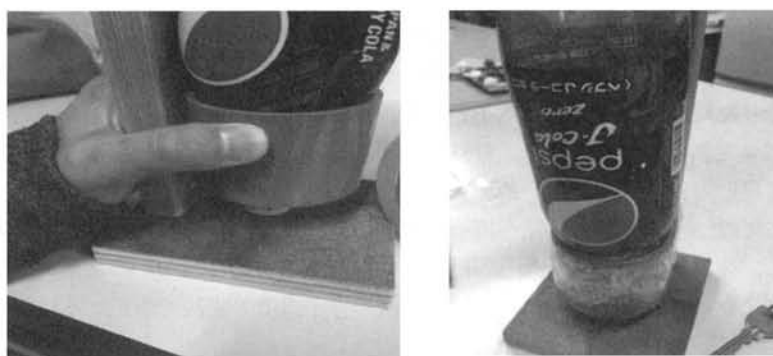
図3 発射台の筒の位置調整 (左) と設置したペットボトルロケット (右)
