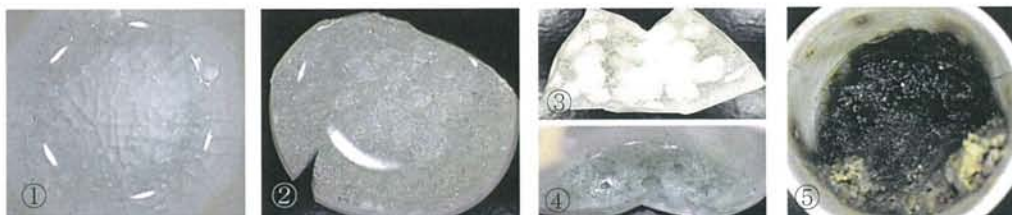
図5 電気炉で加熱したソーダ石灰ガラスの生成 (写真は表3中の番号と対応)
