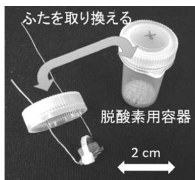
図 8 脱酸素剤による 酸素濃度の制御
