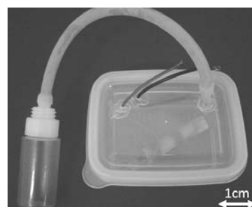
図4 プラスチック容器と点眼瓶を用いた酸素の導入方法
