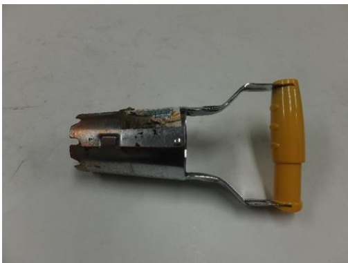
図 2. 実験に用いた (a) 採土器と (b) ツルグレン装置
