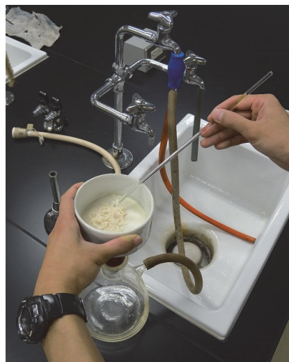
図9 沈殿物の洗浄操作
