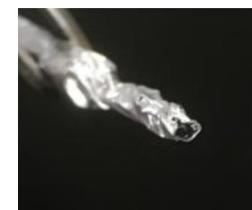
図 6-3 クリップで絞った噴射口
