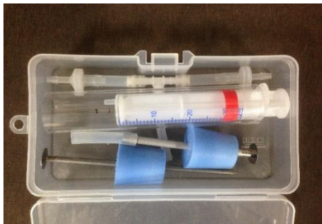
図 4-10 分解した簡易放電実験装置
