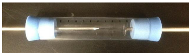
図 4-6 放電管・電極部
