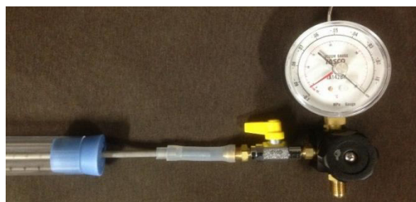
図 4-11 簡易放電実験装置と真空計
