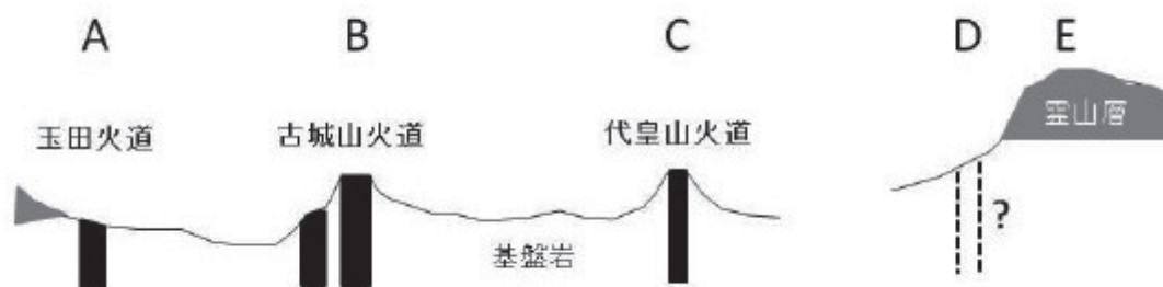
図2 図2の地質断面図 (A～Eを東西線上に投影したもの。八島(1959)を一部改変))
