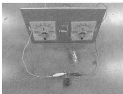
図4 2つの電流計とコンデンサを使った教材
