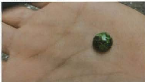
図4 急冷して試料がガラス化した様子
