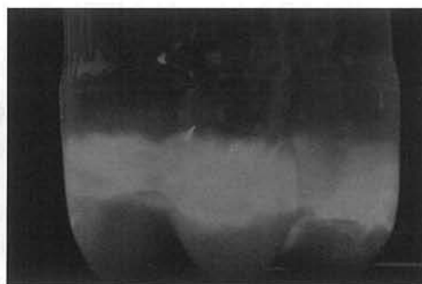
図3 落下定着した結晶 (ペットボトルの径は 8.5cm)
