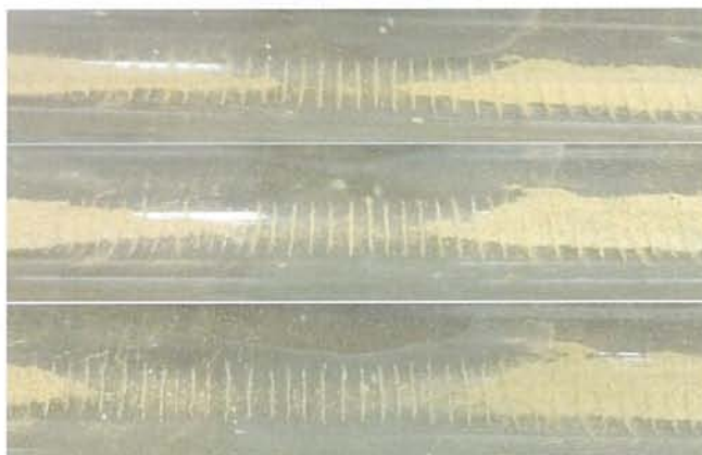
図 17 粒子が腹から節の方移動していく過程（超微細木粉，約 3 分間）
