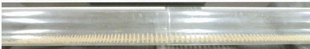
図 14 腹付近（コルク粉，気柱長 60cm，振動数 300Hz，腹中心では 8mm，節よりで 4mm の間隔）
