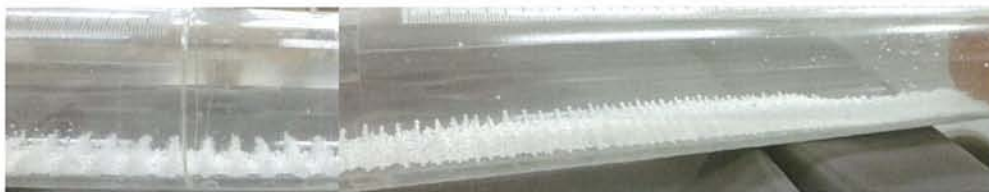
図 14 腹と節付近（発泡ポリスチレン小粒，気柱長 90cm，振動数 95Hz，腹で 7.5mm 節付近で 3mm の間隔）
