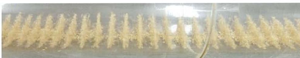
図 15 腹中心部の拡大（コルク粉，気柱長 60cm，振動数 300Hz，腹中心では 8mm の間隔）
