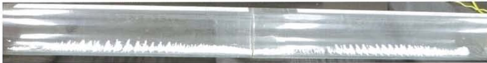
図 8 発泡ポリスチレン小粒 (1.2~1.5mm φ) : やや腹の方に寄る傾向を示すが移動速度は遅く、節付近の粒子は全く動かない。腹付近では粒子が整列して立ち上がる。
