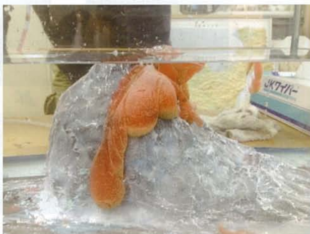
図7 細粒砂を加えた枕状溶岩のモデル
