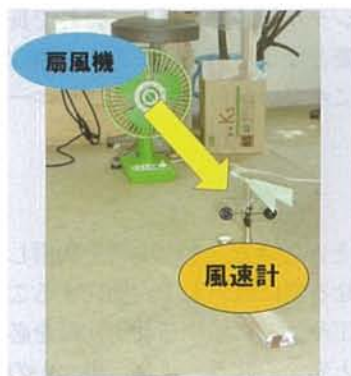
図 10 扇風機を使用した測定の様子
