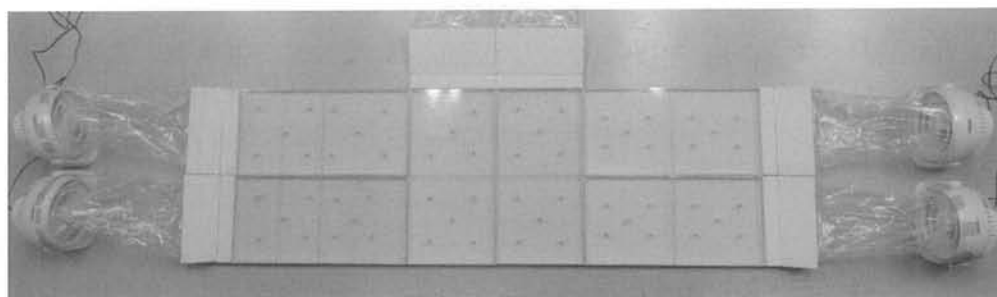
図 3 完成した無摩擦実験台
