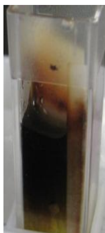
図 10 ヨウ化カリウム水溶液の電気分解後
