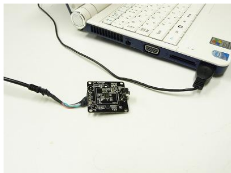
図10 パソコンへ接続したWebカメラ
