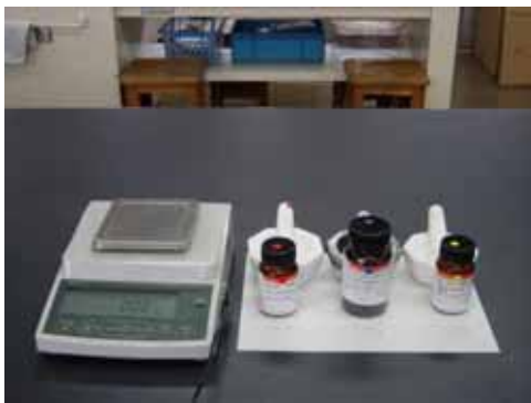
図1 原材料物質の秤量 (薬品, 左から \text{Y}_2\text{O}_3 , \text{BaCO}_3 , CuO)
