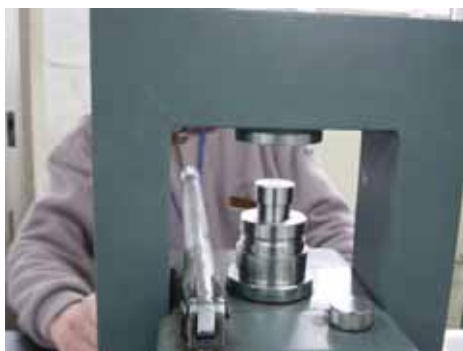
図5 圧縮成型機でペレット作製 ( 500\text{kg}/\text{cm}^2 で5分間圧縮)
