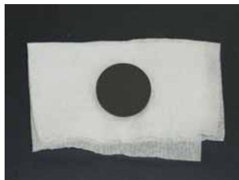
図6 本焼後のY系高温超伝導酸化物 (直径30mm、厚さ2mm)
