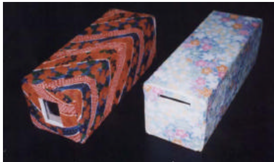
写真4：完成した牛乳パック分光器、 左はグレーティング部、右はス リット部から見た様子
