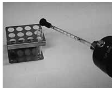
図6 気体検知器による硫化水素濃度の測定
