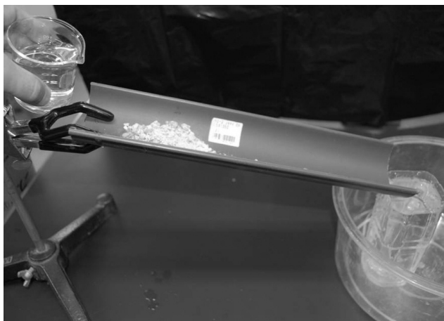
図4 雨どいを用いた堆積実験
