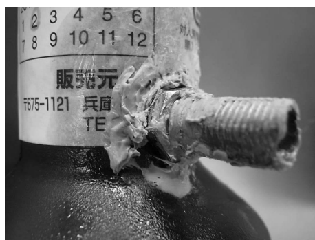
図 7 シリンダーに取り付けたバルブ
