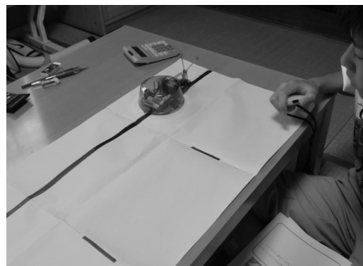
Fig.8 ロボットの進む時間の計測の様子
