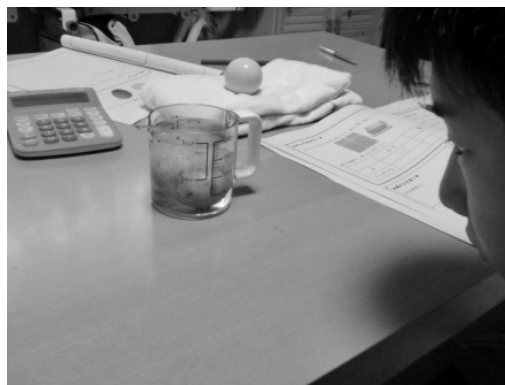
Fig.7 卵の体積の計測の様子
