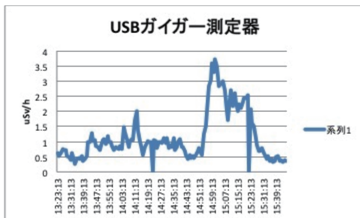
図5 USB ガイガー測定器による東北自動車道の二本松インター手前から南相馬市原町火力発電所まで走行中の毎時の線量当量
