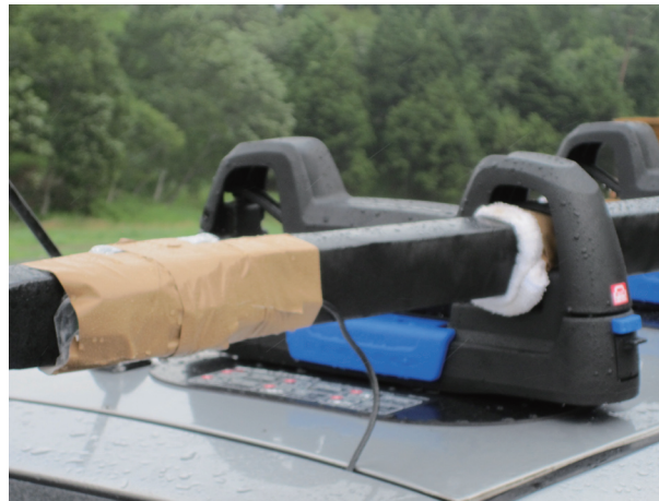
図3 USB ガイガー測定器と DoseRAE2 を車に搭載した様子
