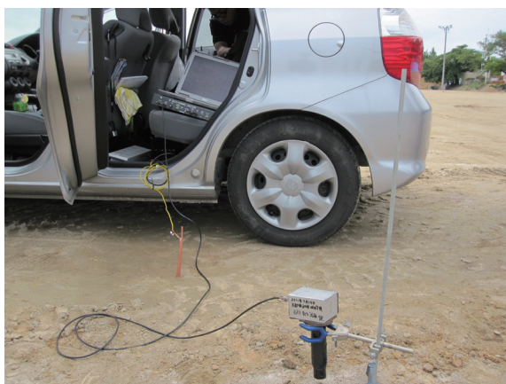
図7 車載放射線計測システムを使った測定の様子
