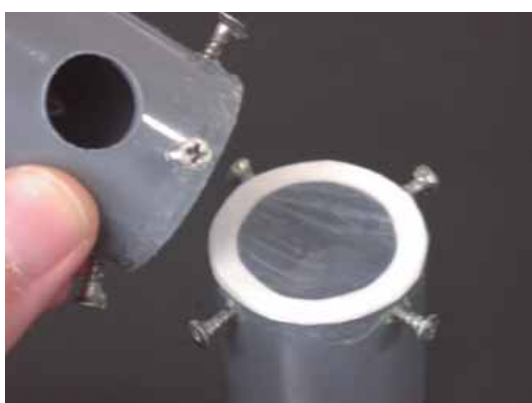
図4 実験装置への膜の取り付け
