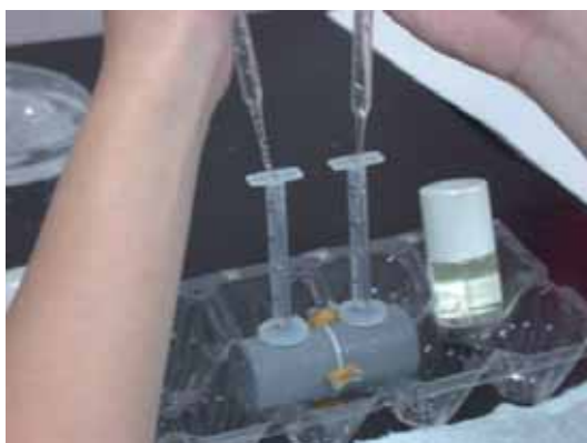
図6 注射筒を取り付け、溶液をさらに満たす
