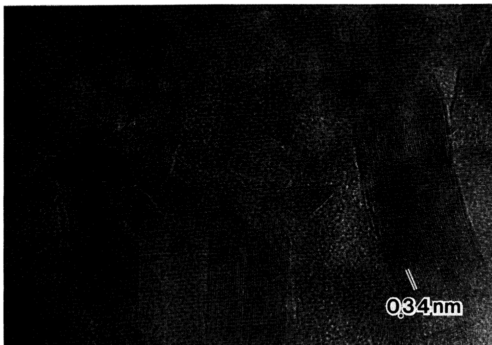
図5 グラファイト単結晶薄膜の (002) 面に対応する面間隔 0.34nm の結晶格子像。c 軸に垂直な層状構造が観察されている。
