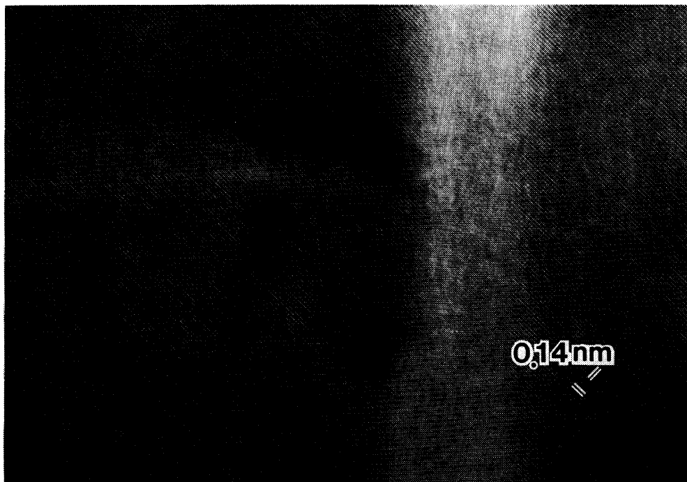
図4 Au エピタキシャル薄膜の結晶格子像。Au (面心立方格子) の (220) 面の交差した 格子縞が観察されている。0.14nm の格子縞間隔は本装置の保証分解能を示している。
